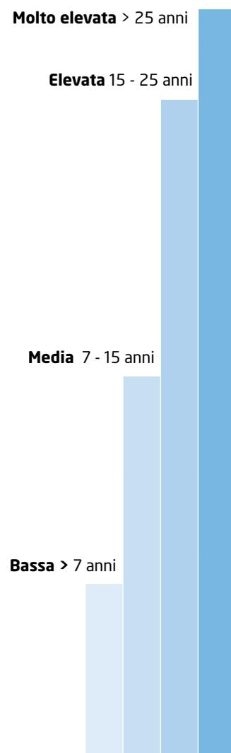
Con un segnaio su substrato di acciaio e acciaio zincato, in conformità allo standard ISO 12944:2018, parti 2-6-9
