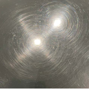
Martindale testinin ardından hassasiyete sahip koyu ve parlak yüzey (80GU)
