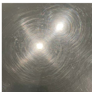
Sensible acabado oscuro y brillante 80GU después de la prueba Martindale
